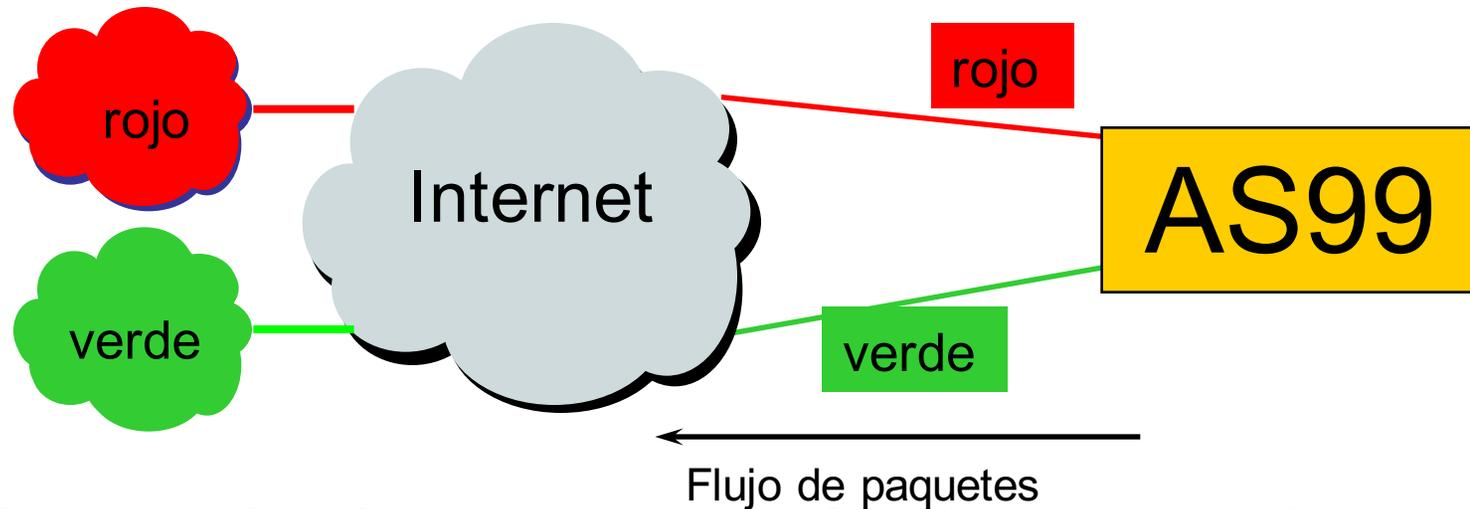
AS99 usa el enlace rojo para el tráfico que va hacia el AS rojo y el enlace verde para tráfico que al AS verde
